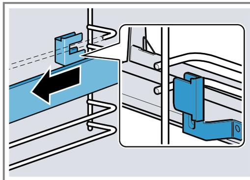
4. Die Auszugsschiene entfernen.
